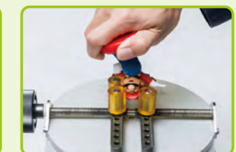
ひねっても簡単に壊れないか、 壊れても安全であることを確認
